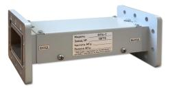
Фильтр ФП4-С устанавливается в разрыв между LNB и облучателем приемной антенны. В данной модели фильтра отсутствуют паразитные резонансные частоты в полосе 8 ГГц при ширине полосы пропускания до 350 МГц.
